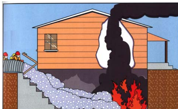
Bild 20, Flutung eines Brandobjekts mit Leichtschäum
