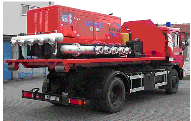
Bild 34, Wechselladercontainer Löschwasserförderung / Schaumerzeugung, Nennleistung 7500 l/min bei 10 bar
