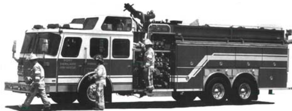
Bild 33, Sonderlöschfahrzeug für Raffinerie-Brandbekämpfung mit einer Pumpenleistung von ca. 13500 l/min bei 10 bar, Motorleistung 500 PS, kombinierter Schaum- Pulvermonitor, Schaumzuschanlage und 7500 Liter Schaummittelvorrat, Pulvervorrat 750 kg, Besatzung 4 Mann (SB)
