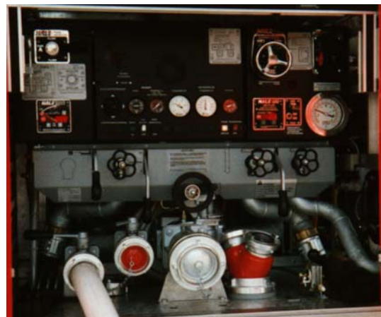
Bild 7, Bedienfeld einer Pumpenanlage mit integrierter CAFS-Anlage. Zu erkennen sind links die Bedieneinrichtungen zum Schaumsystem, die Bedieneinrichtungen der Pumpenanlage in der Mitte und die Bedieneinrichtungen der CAFS-Anlage rechts. Quelle: HALE / Ziegler
